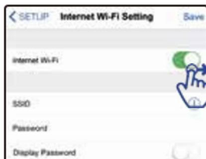
Tras realizar la conexión a la red WIFI el dispositivo se reiniciará, y deberá esperar varios segundos dependiendo del modelo del equipo hasta que se reinicie por completo. Compruebe el indicador LED del dispositivo para verificar que la conexión IP se ha realizado correctamente.
